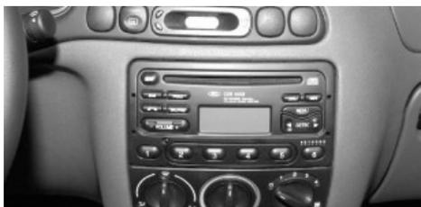
Figura 10. Exemplo de equipamento tamanho *Double DIN*
