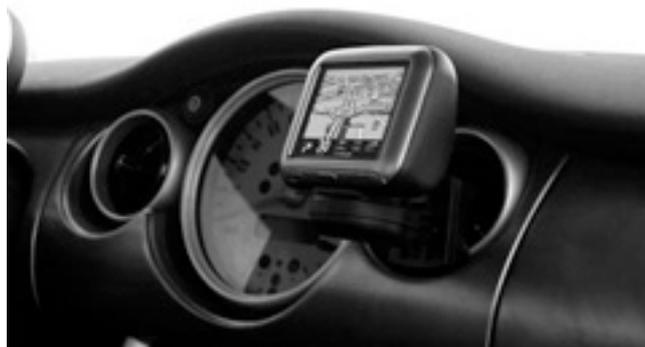
Figura 8. Exemplo de navegador portátil acoplado ao painel de instrumentos
