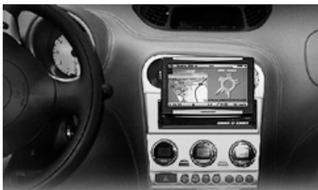
Figura 7. Exemplo de navegador instalado no *center stack* (*aftermarket*)
