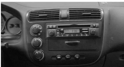
Figura 9. Exemplo de equipamento tamanho *Single DIN*
